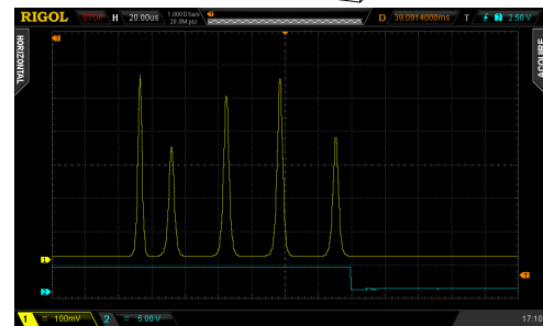
Abb. 28: Laserantwort bei geringer Pumpleistung. Aus der zeitlichen Breite dieser Spikes am Ende des Pumpimpulses lässt sich auch die Kohärenzlänge berechnen.
